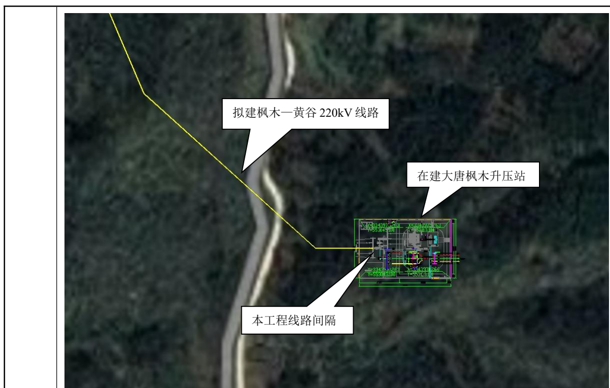
图 2-2 大唐枫木升压站 220kV 进出线平面图
