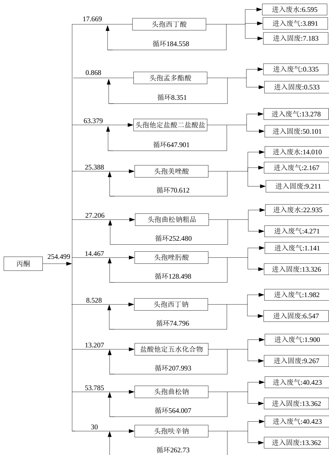
图 4.5.1-7 拟建项目丙酮平衡示意图 单位: t/a
