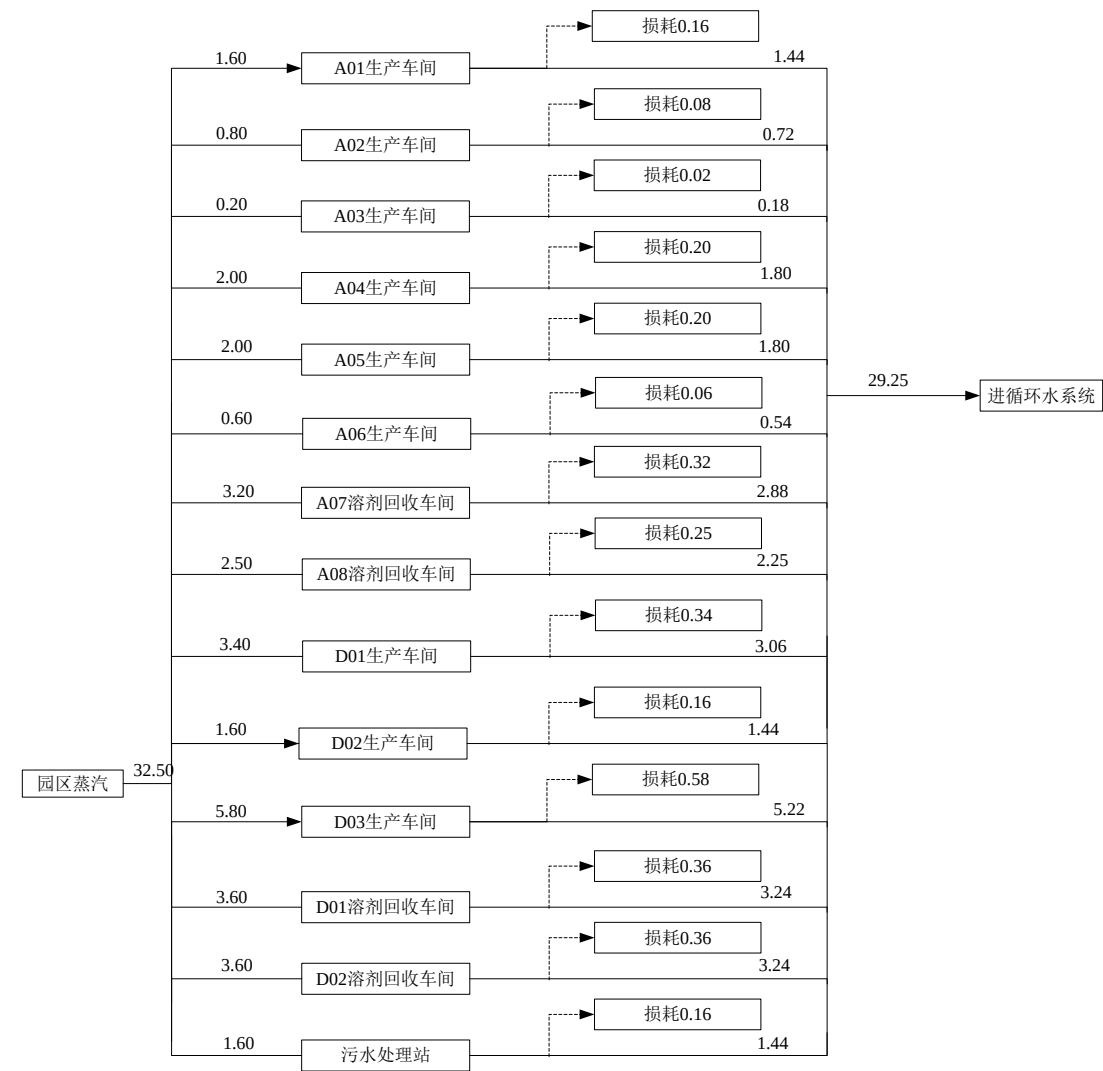
图 4.5.2-2 拟建项目实施后整个厂区（叠加现有及在建项目后）蒸汽平衡示意图 单位：t/h
