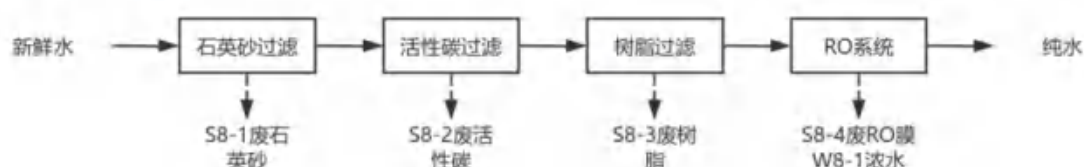
图 3.2-11 纯水制备工艺流程、产污环节示意
