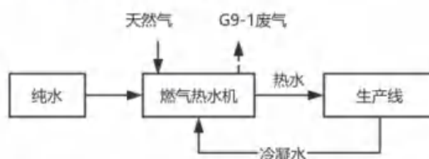
图 3.2-12 热水制备工艺流程、产污环节示意
