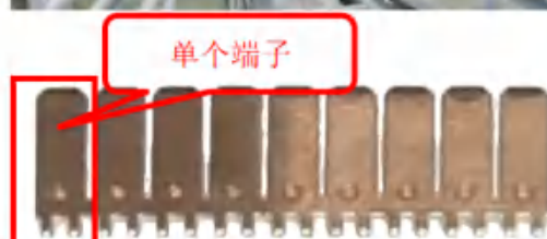
端子示意图（带料连续电镀）
