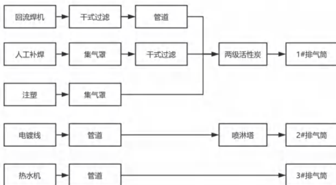
图 3.4-1 各类废气收集处理方式示意图
